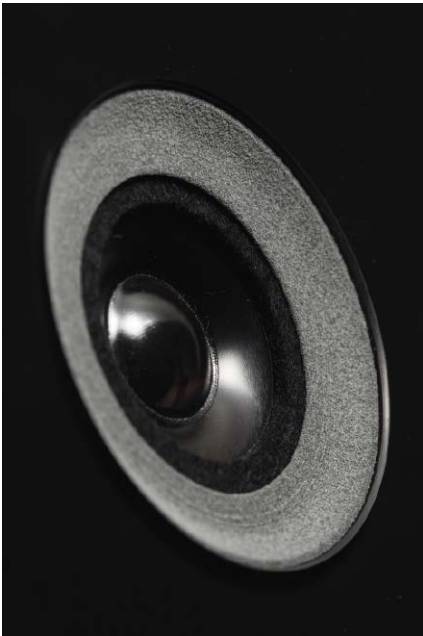
Przetwornik wysokotonowy ma membranę stożkowo-kopułkową, a wokół niego uformowano płytki profil (falowód?) z gąbki – tym razem gęstej i miękkiej
