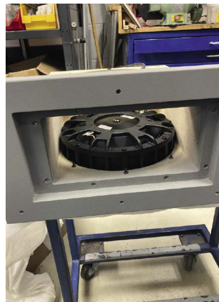
Moduł już połączony z dolną ścianką obudowy, przez jej otwór widoczny tył jednego głośnika (drugi jeszcze niezainstalowany).
