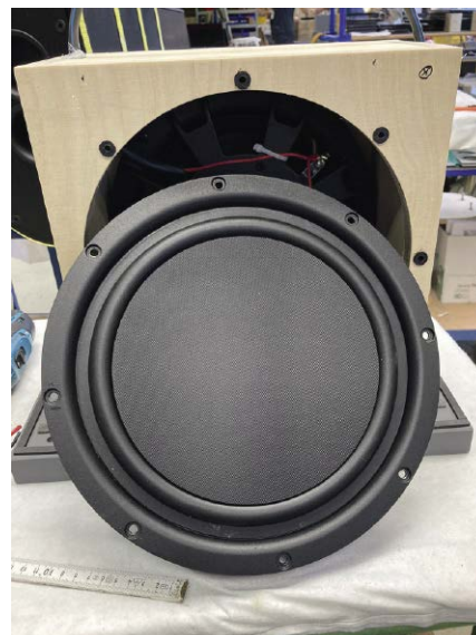
Wewnętrzny moduł, a przed nim jeszcze niezainstalowany przetwornik niskotonowy (od frontu).
